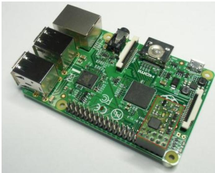
Abbildung: PRG610 auf einem Raspberry-Pi-Board (rot umrandet)
