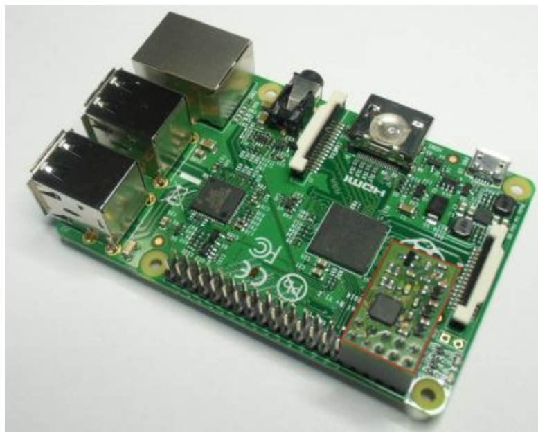
Abbildung: PRG620 auf einem Raspberry-Pi-Board (rot umrandet)
